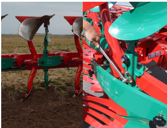
Sistema di protezione dei corpi a rilascio con balestre Auto-reset di Kverneland (sinistra) e la regolazione centralizzata della profondità di lavoro degli avanvomeri (destra).
